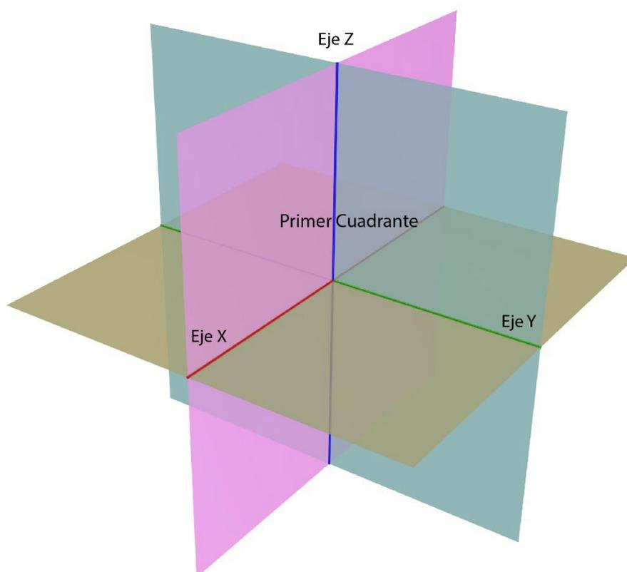
*En la figura se representan los cuadrantes del espacio y se destaca el primero de ellos y las direcciones positivas de los ejes X, Y y Z, con los colores que utilizaremos.*
